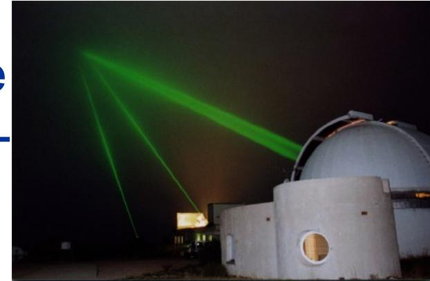
L'effet croisé de la répartition du réseau d'observation LASER et des mouvements saisonniers de la croûte induit des erreurs de l'ordre du millimètre sur un mouvement dont l'amplitude saisonnière est de cinq millimètres.
