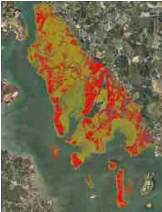
Figure 8 : Projection des points laser (données SHOM) classés (rouge=sursol, jaune=sol, bleu=bas sursol) sur une ortho-image.
