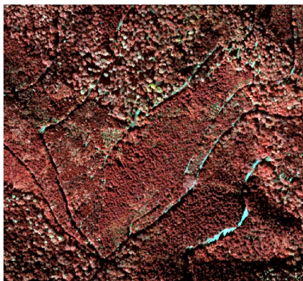
Simulation d'image aérienne rouge – red-edge – proche infrarouge d'après la configuration du capteur hyperspectral
